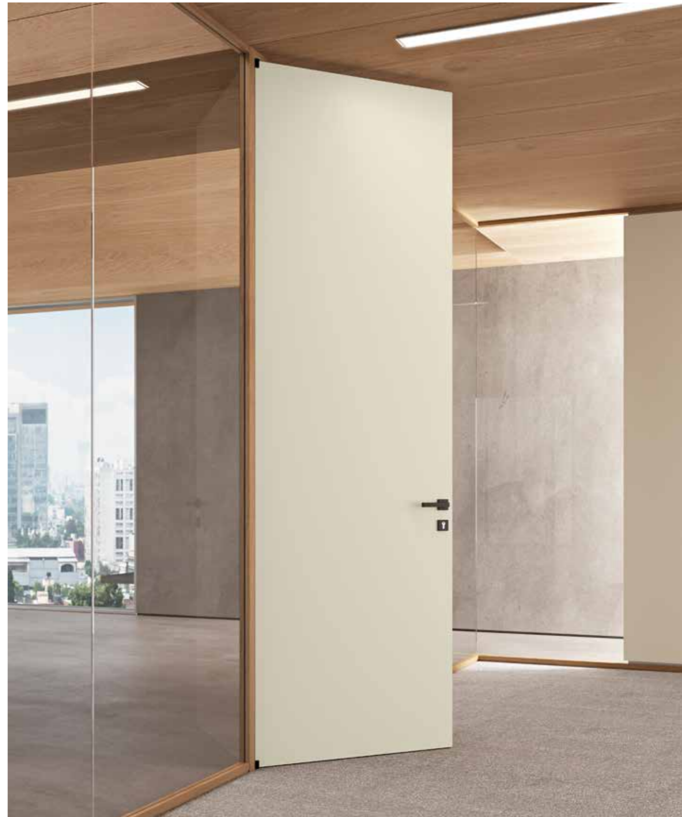
Profili in alluminio finitura Wood A-LG25 Rovere, porta in finitura S-0003-2 Avorio, maniglia Geneve finitura nera. Modulo cieco con doppio pannello in melaminico S-0003-2 Avorio spessore 18 mm cadauno. Porta a tutta altezza in tamburato spessore 43 mm, vano tecnico 150x52 mm a tutta altezza in alluminio finitura Wood A-LG25 Rovere per il posizionamento di badge, prese e interruttori
